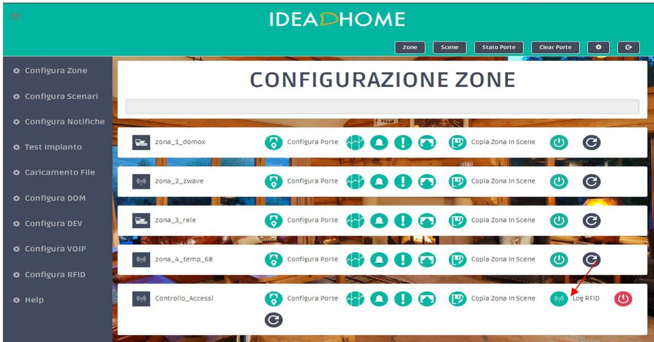
Su Configura Zone, in corrispondenza della riga della zona controllo accessi comparirà sul lato destro il pulsante **LOG RFID**, basta cliccarlo per accedere alla sezione storico.
