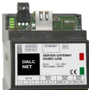
Il modulo di controllo via ethernet su rete web o rete locale interfaccia il dispositivo DGM01 il quale acquisisce le informazioni provenienti da rete ethernet, e le ritrasmette verso i bus configurati in trasmissione, convertendo in tempo reale le informazioni tra molteplici protocolli.
